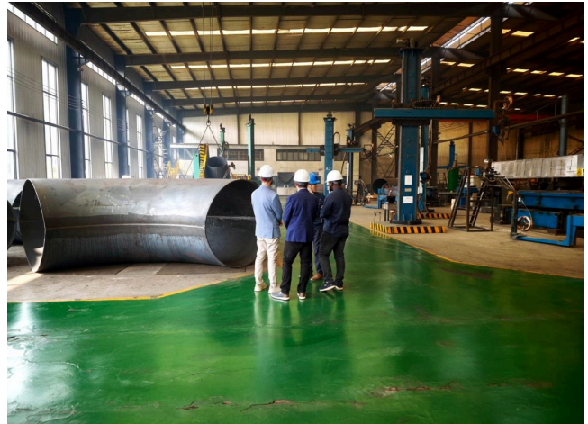
Curvas de grande diâmetro na zona de soldadura.
