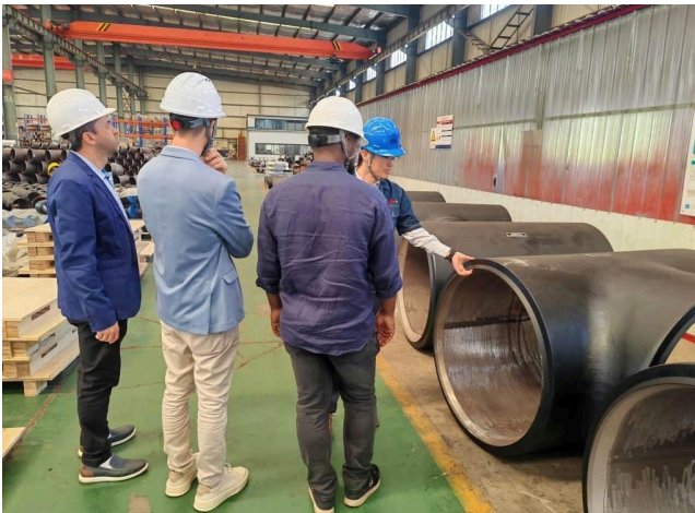
Tês inspecionados: espessura e acabamento.
