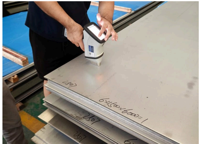
Ensaio XRF para confirmar a composição da liga.
